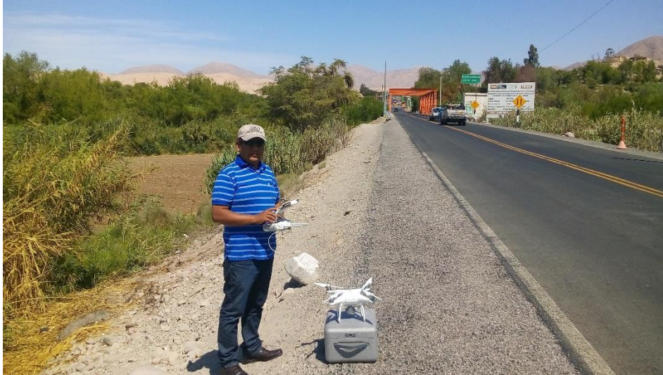
Figura 48. Preparación e Inicio de Levantamiento Topográfico con Dron en el Puente Montalvo
