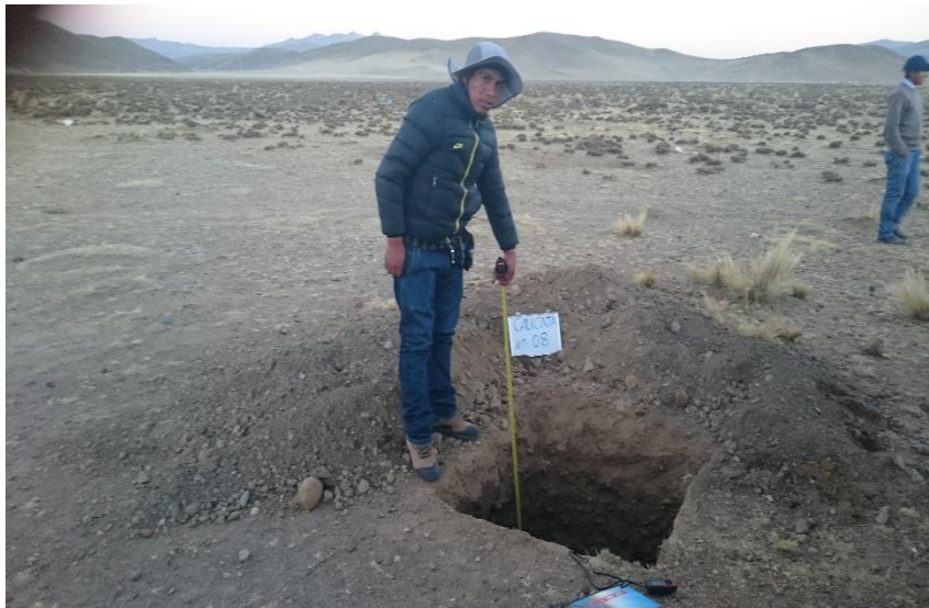
Figura 17. Excavación calicata N° 02
