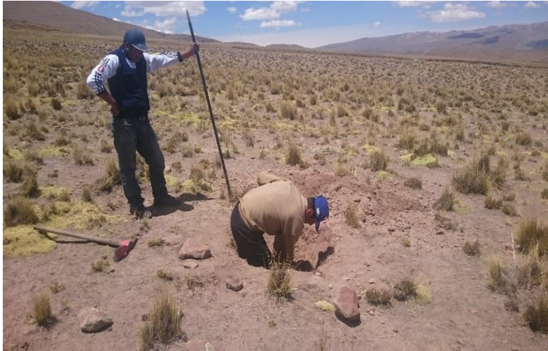
Figura 19. Excavación calicata N° 04
