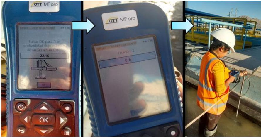
Figura 32. Medición de velocidad - canaleta Parshall
