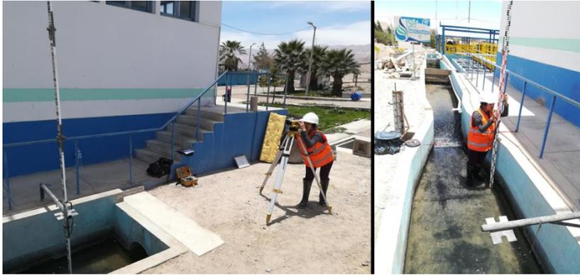
Figura 29. Verificación de dimensiones 1 - canaleta Parshall
