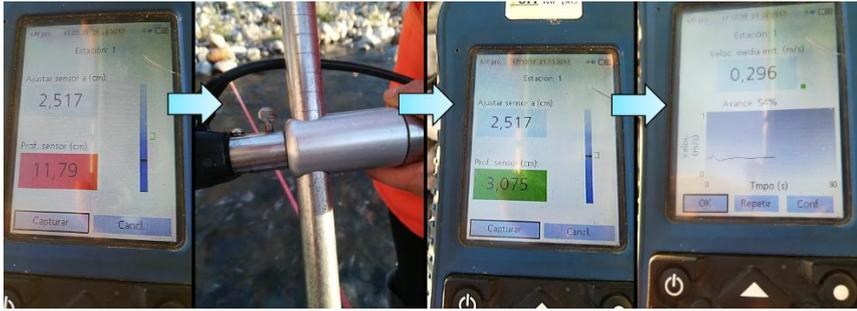
Figura 17. Medición de velocidad a 20 %
