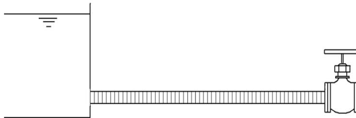
Figura 11. Depresión en toda la tubería
