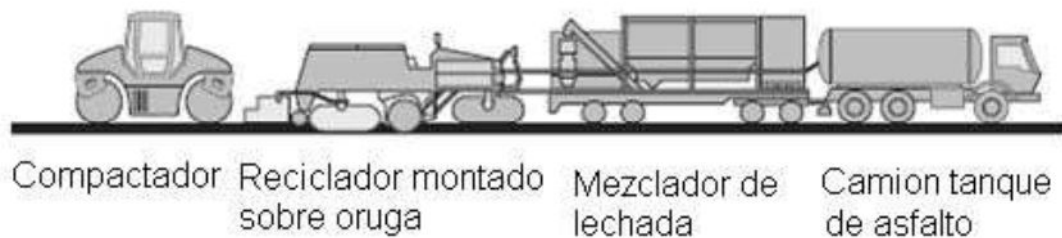
Figura 13. Etapas del reciclado y equipos usados Fuente: Mercado, 2008
