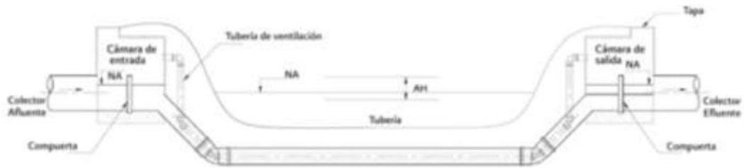
Figura 2. Sifón con ramas oblicuas Fuente: Comisión Nacional del Agua de México, 2009
