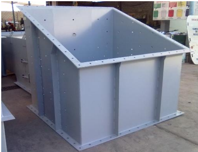
Figura 10. Bridas cuadradas del chute de descarga
