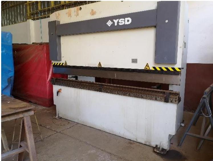
Figura 14. Dobladora hidráulica en taller metal mecánico
