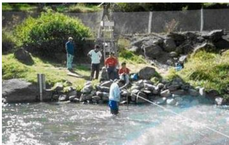
Figura 16. Mediciones de profundidad para cada sección del cauce
