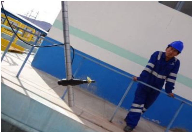
Figura 25. Muestra de la barra y del Molinete del correntómetro 3000.
