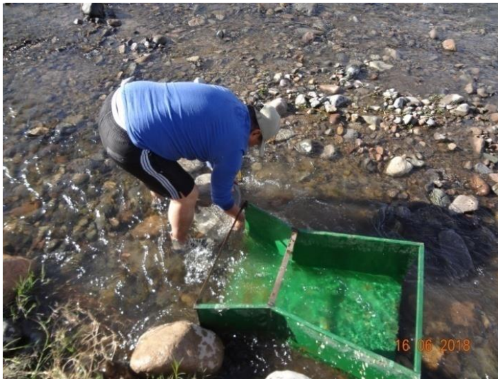
Figura 11. Medición de los Valores de H_a y H_b y B del aforador
