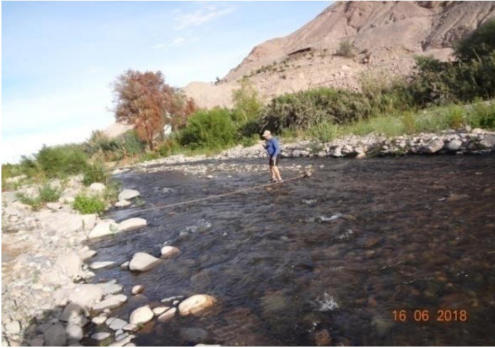
Figura 39. Medición del tiempo de recorrido del flotador
