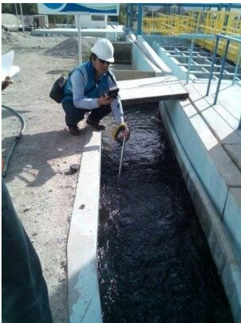
Figura 28. Midiendo la velocidad de la sub sección 2 del canal
