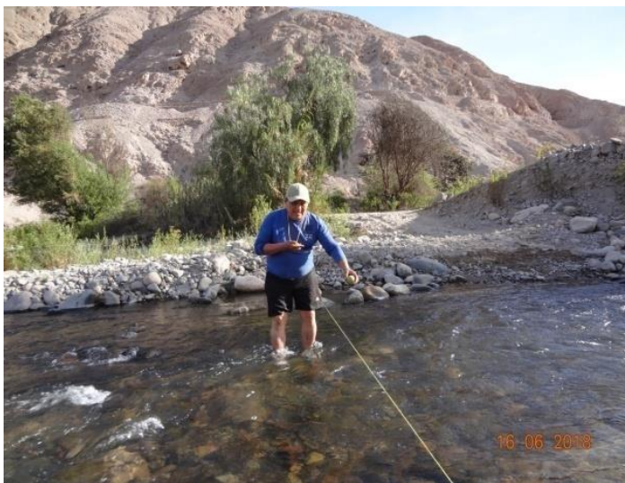
Figura 38. Vista del lanzamiento del flotador
