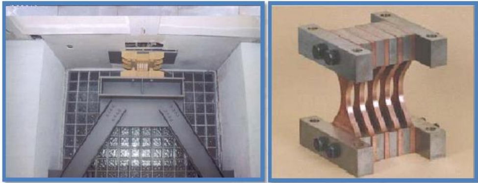
Figura 6. Dispositivo de amortiguación por fluencia metálica ADAS.
