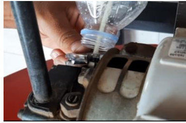
Figura 15. Cebado de la bomba de combustible.
