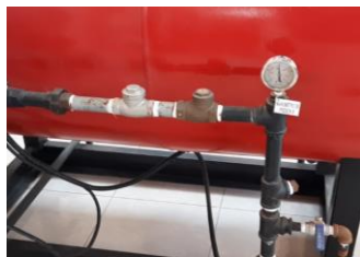
Figura 28. Recomendación de dos válvulas antirretorno.
